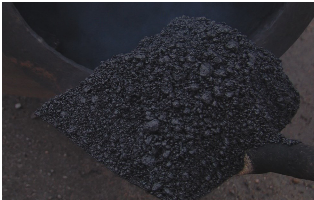
8-сурет – Регенерацияланған асфальтбетон қоспасын дайындау процесі
